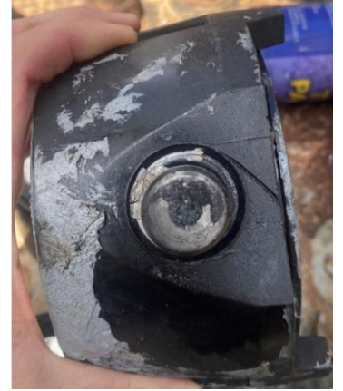
شکل نمبر ۲: واقعے کے دوران بند پریشر گیج (Plugged)
