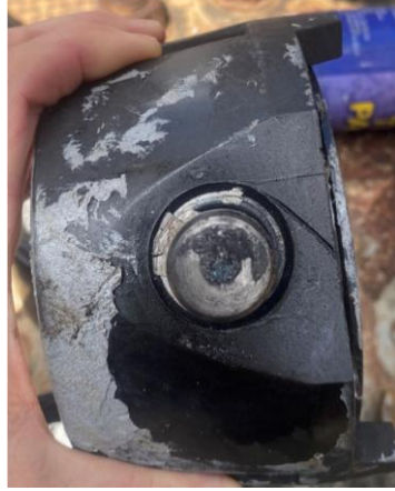
Şekil 2. Olaydan sonra tıkanan basınç göstergesi
