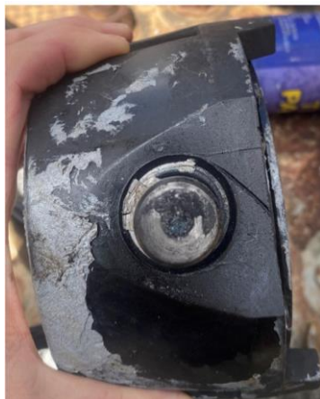
Figura 2. Manómetro obstruido del incidente
