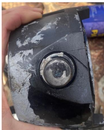
Figura 2. Manômetro entupido do incidente
