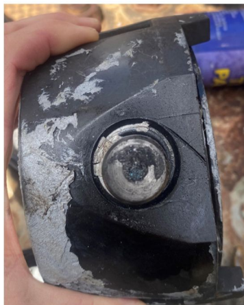
Figura 2. Manometro ostruito durante l'incidente
