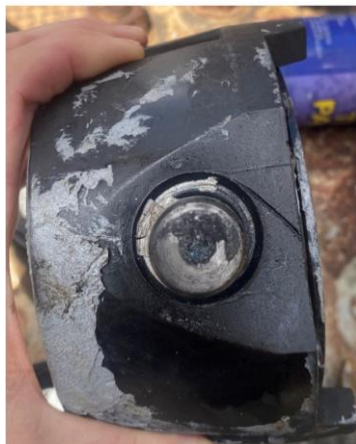
Εικόνα 2. Φραγμένο μανόμετρο από το συμβάν
