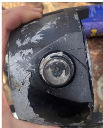
Figuur 2. Verstopte manometer van het incident
