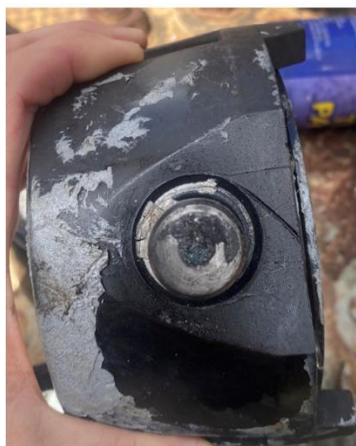
圖2：事故中發現的堵塞壓力錶
