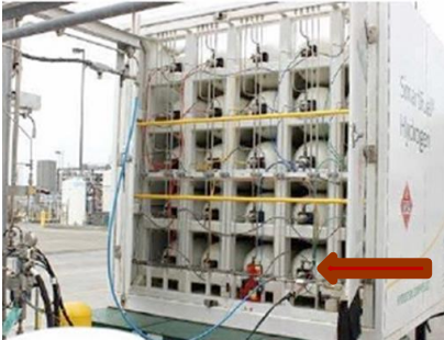
รูปที่ 1 การบรรจุไฮโดรเจนลงท่อนรถเทรลเลอร์ (tube trailer)
