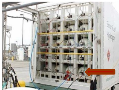
Rysunek 1. Napełnianie przyczepy (rurowozu) z butalnymi
