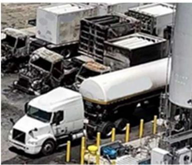
그림 2. 충전 중인 트랙터-트레일러 손상
