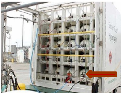
Figura 1. Riempimento di un rimorchio a bombole (tube-trailer) di idrogeno
