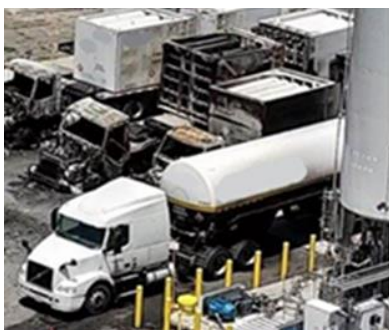
Kuvio 2. Traktorin ja perävaunun vauriot
