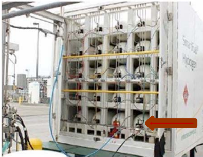
圖1：氫氣管束拖車填充示意
