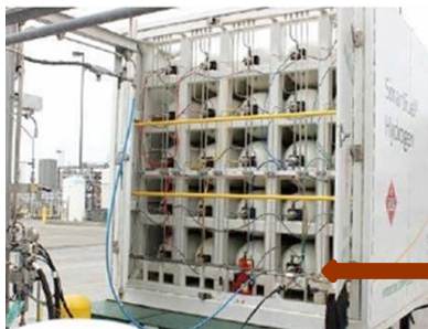
Фигура 1. Зареждане на тръбно ремарке за превоз на водород
