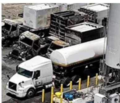
Фигура 2. Повреда на цистерна при зареждане с гориво
