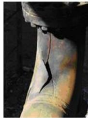
Figura 2. Esquerda, esquema para o incidente de 2007, baseado no Relatório CSB No. 2007-05-I-TX. Direita, cotovelo de entrada partido (CSB)
