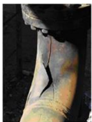
2. ábra: balra egy 2007-es esemény sematikus ábrája (CSB Report No. 2007-05-I-TX). Jobbra a megrepedt belépő könyök (CSB)
