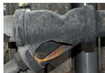
תמונה 1: מימין, תרשים של אירועי 2019. משמאל, מסנן קרוע, שמסומנת בתרשים באדום.
