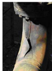
איור 2: מימין, תרשים של אירוע משנת 2007 בהתבסס על דוח CSB מס' TX-I-2007-05. משמאל, זווית כניסה סדוקה (CSB).
