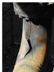
Abb.2: Links, Fließbild zum Vorfall von 2007, nach CSB Report No. 2007-05-I-TX. Rechts, geborstener Bogen „CRACKED inlet elbow“ gemäß Fließbild (CSB)
