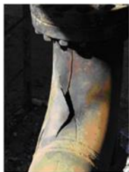
Kuvio 2. Vasemmalla, kaavio vuoden 2007 tapauksesta, perustuu CSB:n raporttiin nro 2007-05-I-TX. Oikea, haljennut putkikäyrä (CSB)
