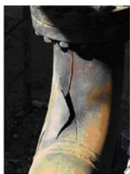
Figuur 2. Links: schematische weergave van het incident in 2007, gebaseerd op CSB-rapport nr. 2007-05-I-TX. Rechts: gescheurd inlaatbochtstuk (CSB).
