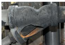
Figuur 1. Links: schematische weergave van het incident in 2019 (CSB-rapport nr. 2019-02-I-TX). Rechts: de gebarsten zeef (CSB), afkomstig uit het rode cirkelgebied in de schematische tekening.
