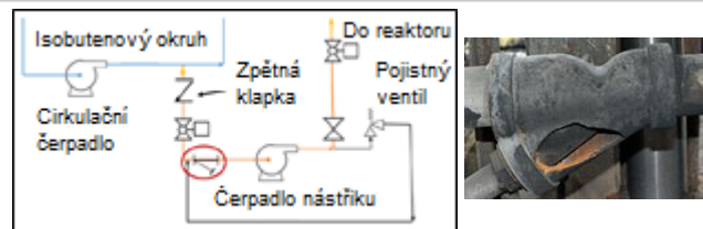
Obrázek 1: Vlevo, schéma havárie z roku 2019 (zpráva CSB č. 2019-02-I-TX). Vpravo, prasklý filtr (CSB), na schématu zakroužkovaný červeně.
