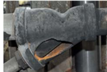
圖1. 左：2019 年事故示意圖（資料來源：美國化學品安全委員會 CSB 報告 2019-02-I-TX）。右：爆裂的過濾器實物照片（來自紅圈所示位置）。
