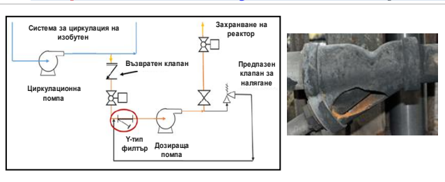
Фигура 1. Вляво, схема на инцидента от 2019 г. (Доклад на CSB № 2019-02-I-TX). Вдясно, разкъсаният филтър (CSB), обозначен с червен кръг на схемата.
