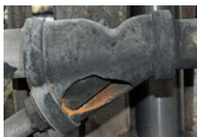
Фигура 1. Вляво, схема на инцидента от 2019 г. (Доклад на CSB № 2019-02-I-TX). Вдясно, разкъсаният филтър (CSB), обозначен с червен кръг на схемата.
