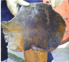
1. ábra: a felhasadt cső darabja
