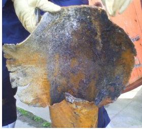
Figuur 1: De gescheurde ovenbuis
