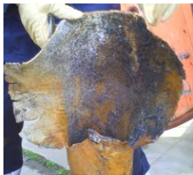
Figur 1: Det revnede rør
