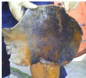
图1 破裂的管子
