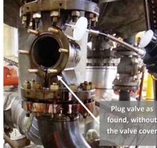
그림 3. 사고 발생 후의 밸브. 밸브커버가 날라간 상태
