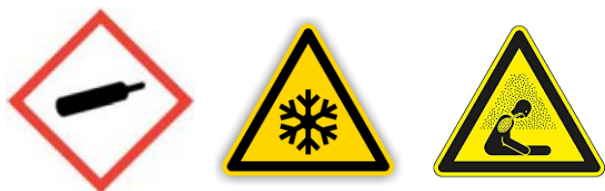
Abbildung 2: Warnhinweise für Gefahren, die von flüssigem Stickstoff ausgehen (Quelle: GESTIS-Stoffdatenbank)
