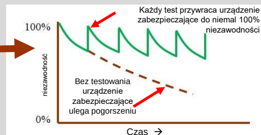
Rys. 4: Niezwadność urządzenia bezpieczeństwa (H 2 S alarm)
